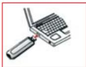
Prima di collegare il modem ricordati di accendere il computer, altrimenti il software non verrà installato correttamente.
